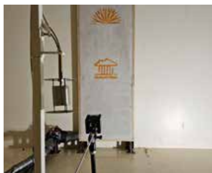
Testování tepelných výkonů v klimatické komoře (instalace na stěnu).
