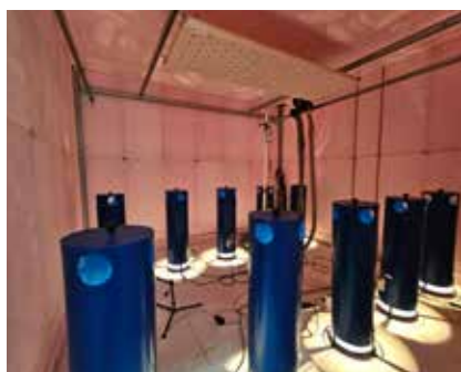
Testování chladících výkonů v klimatické komoře (instalace na strop) ve variantě montáže s předstěnou z akustického sádkkartonu.
