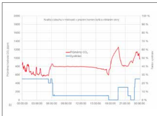
Obrázek 3: Příklad faktoru vyvětrání a hodnoty CO 2 během letního dne pro vyváženě větraný byt (a) a pro byt s ručním vyvětráním okny (b).
