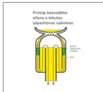
Princip bezvodých sifonů s tekutou zápachovou uzávěrou. V případě propláchnutí větším množstvím vody hrozí riziko vyplavení tekuté zápachové uzávěry. Proto je proplachování zakázáno.
