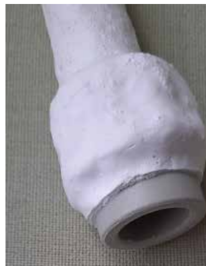
Obr. 6 Očištěný konec PP potrubí
