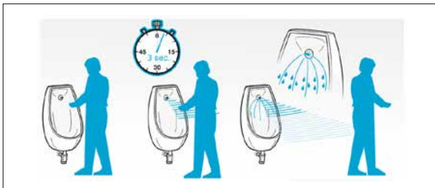
Infračervený senzor detekuje od uživatele odražené světlo.
