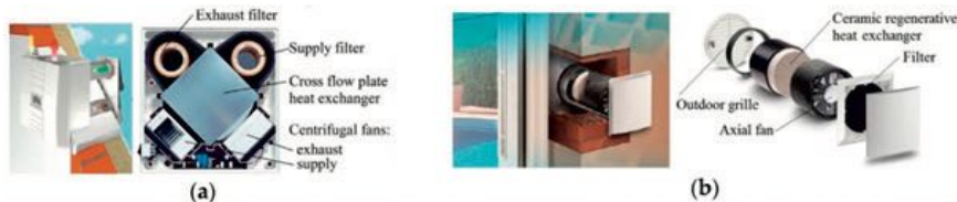
Studie porovnávala jednotky s odlišnými parametry: (a) zařízení s rekuperačním protiproudým výměníkem HEX s příčným průtokem vzduchu se dvěma radiálními ventilátory a (b) jednotku s regeneračním keramickým HEX a axiálním ventilátorem.
