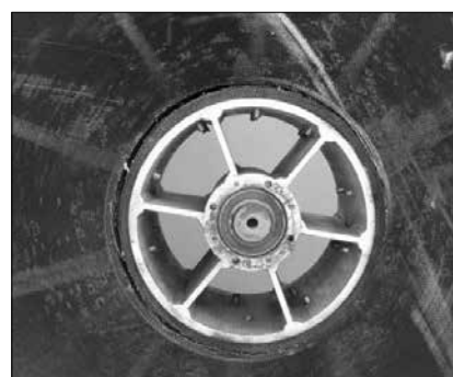
Obr. 7 – Ukázka zdeformovaného ložiska hřídele
