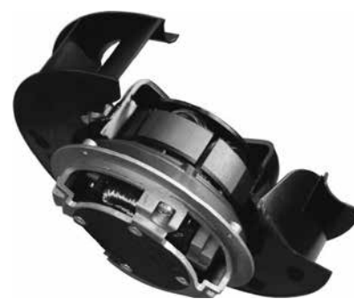
Obr. 3 Moderní provedení radiálního ventilátoru s dozadu zahnutými lopatkami. V obnažené části motoru je vidět vnější rotor s permanentními magnety, uvnitř cívkou vinutí statoru. Vnější rotor je přímo konstrukčně spojen s oběžným kolem ventilátoru
