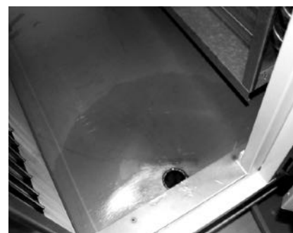
Obr. 3 Ukázka testování spádu dané vany na kondenzát
